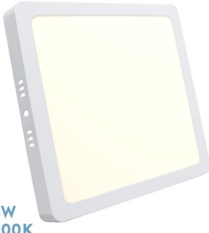
Downlight de superficie cuadrado de la serie SELENITA, realizado en aluminio color BLANCO y policarbonato. Posee TECNOLOGÍA LED INTEGRADO, con una potencia de 24 watos, 2160 lúmenes y una temperatura de luz de 4000K, blanco natural. Tiene unas dimensiones de 2,8x28,5x28,5 centímetros. En esta serie podemos encontrar downlight de 6, 12, 18 y 24 watos, tanto en luz fría (6000k) como en blanco natural (4000k) y en sus correspondientes tamaños.
