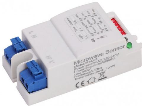
Sensor de movimiento DETECTOR de largo y corto alcance, encendiendo la luz ante cualquier tipo de movimiento de 2 a 8 metros, con tiempo de encendido programable desde 8 segundos a 12 minutos y sensor con ángulo de cobertura de 360°. También detector de luz programable con 4 programas (día-30Lux-20Lux-10Lux). Tiene una dimensión de 3,6x7,8x2,5 centímetros y un peso neto de 40 gramos.
