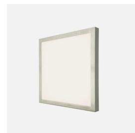
Panel de superficie de la serie PLANO en color NIQUEL. Realizado en aluminio y policarbonato. Tiene una potencia de 36 vatios, 3060 lúmenes y 4000K de temperatura de luz, blanco natural. Tiene una medida de 3,5X40X40 centímetros y un peso neto de 1010 gramos. En esta serie podemos encontrar varios tamaños de paneles de superficie, con sus correspondientes potencias, tanto en color blanco como en níquel.
