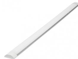
Regleta de la serie SERGIN de color blanco con LED INTEGRADO. Realizado en aluminio y policarbonato. Tiene una potencia de luz de 36 watos, 3600 lúmenes y 6000k de temperatura de luz (blanco frío). Tiene unas dimensiones de 2,5x120x7,5 centímetros y su peso neto es de 460 gramos. En esta serie encontramos las regletas con 18w, 36w y 48 watos con sus tamaños correspondientes, todas disponibles tanto con luz natural (4000K) como con luz fría (6000K).
