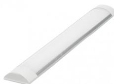
Regleta de la serie SERGIN de color blanco con LED INTEGRADO. Realizado en aluminio y policarbonato. Tiene una potencia de luz de 18 vatios, 1800 lúmenes y 6000k de temperatura de luz (blanco frío). Tiene unas dimensiones de 2,5x60x7,5 centímetros y su peso neto es de 250 gramos. En esta serie encontramos las regletas con 18w, 36w y 48 vatios con sus tamaños correspondientes, todas disponibles tanto con luz natural (4000K) como con luz fría (6000K).
