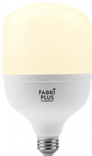
Bombilla LED de ALTA POTENCIA de la serie FABRIPLUS, realizada en policarbonato blanco y metal. Con portalámparas E27, tiene una potencia de luz de 50 vatios, 4500 lúmenes y 3000 K de temperatura de luz, luz cálida. Sus medidas son de 22,3X14X14 centímetros y tiene un peso neto de 225 gramos.
