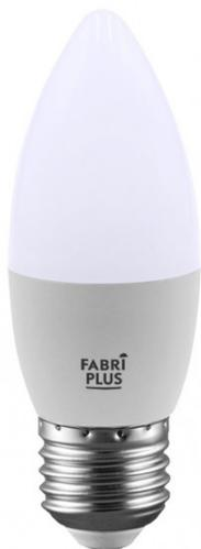
Bombilla LED VELA de la serie FABRIPLUS, realizada en policarbonato blanco y metal. Con portalámparas E27, tiene una potencia de luz de 7 vatios, 630 lúmenes y 6000 K de temperatura de luz, blanco frío. Sus medidas son de 10,6X3,7X3,7 centímetros y tiene un peso neto de 25 gramos.
