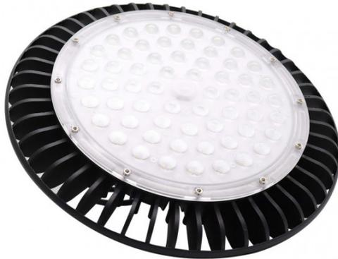
Campana led de la serie MONZONITA realizada en aluminio y policarbonato. De color NEGRO. Tiene unas medidas de 12,5X30X30 centímetros y un peso neto de 3280 gramos. Su potencia de luz es de 150 vatios y 16500 lúmenes, con una temperatura de luz de 6500K (blanco frío). Tiene un índice de protección IP65 y un ángulo de luz de 120°. Disponible en esta serie de 100, 150 y 200 vatios con sus tamaños correspondientes.
