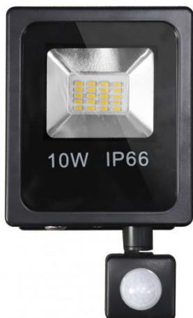
Proyector de la serie OLIVINO con sensor de movimiento en color NEGRO. Realizado en aluminio, cristal y policarbonato. El sensor es articulado, de manera que puede orientarse con una movilidad de 360° hacia la zona que más interese. Tiene una potencia de 10 vatios y 900 lúmenes, con una temperatura de luz de 6500°k (luz fría). Tiene unas dimensiones de 19x11,5x5 centímetros. Con un índice de protección IP66, resistiendo así al polvo y el agua.
