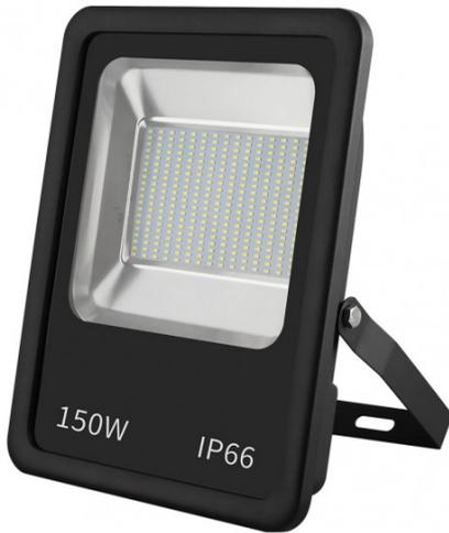
Proyector led serie DACITA realizado en aluminio y cristal. De color NEGRO. Tiene unas medidas de 42,5x32,5x8 centímetros y un peso neto de 3330 gramos. Su potencia de luz es de 150 vatios y 13500 lúmenes. Con una temperatura de color de 6500K. Tiene un índice de protección IP66 y un ángulo de luz de 120º.
