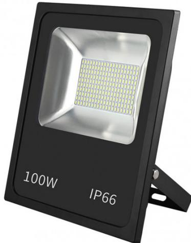
Proyector led serie DACITA realizado en aluminio y cristal. De color NEGRO. Tiene unas medidas de 35,5x28,5x6,5 centímetros y un peso neto de 2455 gramos. Su potencia de luz es de 100 vatios y 9000 lúmenes. Con una temperatura de color de 6500K. Tiene un índice de protección IP66 y un ángulo de luz de 120º.
