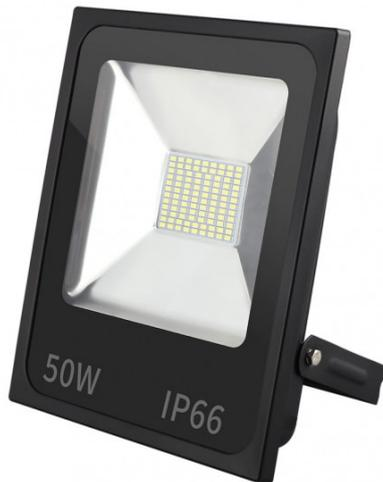
Proyector led serie DACITA realizado en aluminio y cristal. De color NEGRO. Tiene unas medidas de 28,5x24x5,5 centímetros y un peso neto de 1535 gramos. Su potencia de luz es de 50 vatios y 4500 lúmenes. Con una temperatura de color de 6500K. Tiene un índice de protección IP66 y un ángulo de luz de 120º.
