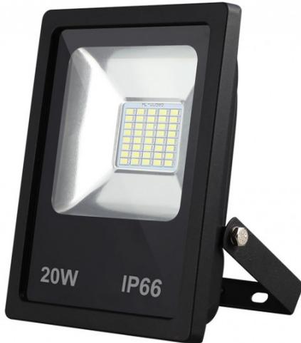
Proyector led serie DACITA realizado en aluminio y cristal. De color NEGRO. Tiene unas medidas de 18,5x15,5x4,5 centímetros y un peso neto de 665 gramos. Su potencia de luz es de 20 vatios y 1800 lúmenes. Con una temperatura de color de 6500K. Tiene un índice de protección IP66 y un ángulo de luz de 120º.
