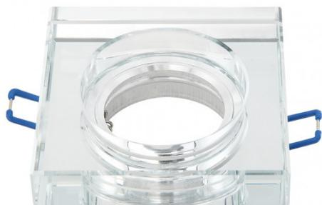
Empotrable cuadrado serie SOLNA realizado en cristal, aluminio y terminación de espejo. Moderno diseño, con un canto o grosor de 2 centímetros, aporta elegancia a la estancia que ilumina. Sus dimensión es de 2x9x9 centímetros. Viene con portalampara GU10. Bombilla no incluida. Corte redondo para su instalación de 6 centímetros de diámetro. En esta misma serie podemos encontrar el mismo diseño en redondo y con canto de 1 o 2 centímetros.
