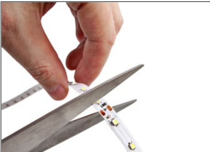
Las tiras LED pueden cortarse y empalmar para conseguir la longitud adecuada.
