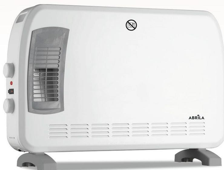
Un convector eléctrico es un sistema de calefacción que trabaja por convección. Su funcionamiento es sencillo: en su interior contienen unas resistencias que, cuando se conectan a la corriente eléctrica, calientan el aire que circula a través de ellas y lo elevan expulsándolo al exterior por unas rejillas.
